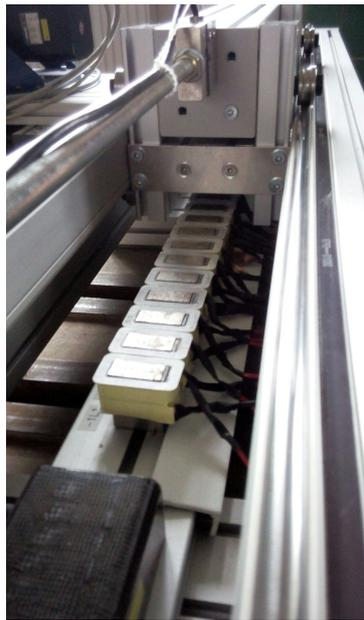
Abbildung 1.4: Linearmotor zur Positionierung
