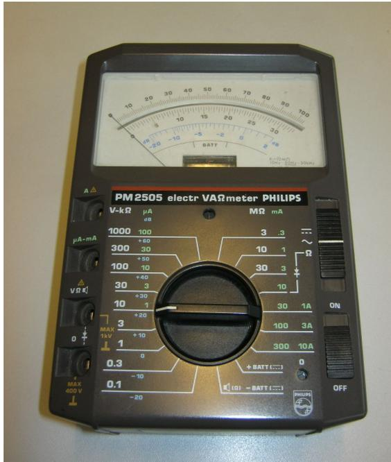
(a) Analoges Multimeter
