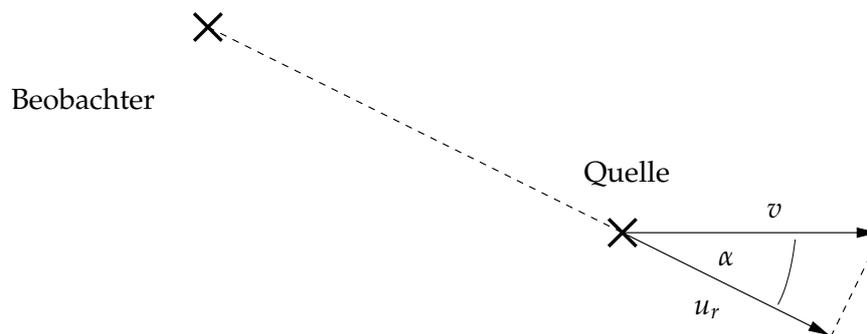
**Abb. 4.3:** Größen beim Doppler-Effekt.  $\alpha$  ist der vom Geschwindigkeitsvektor  $v$  der Quelle und dem Vektor Beobachter-Quelle eingeschlossene Winkel.
