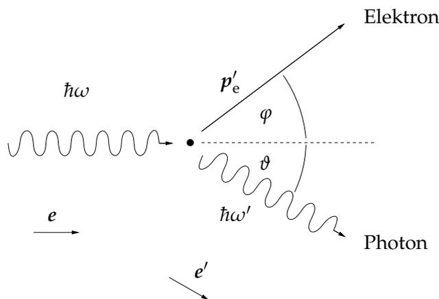
Abb. 4.1: Geometrie des Stoßes beim Compton-Effekt
